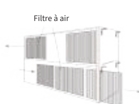
Filtre séparé en 3 parties (accès maintenance sur deux côtés)
